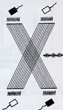
Slika 74. – Nastanak interferentnih struja ukrštanjem linija sile dva kola naizmjeničnih struja srednje frekvencije
